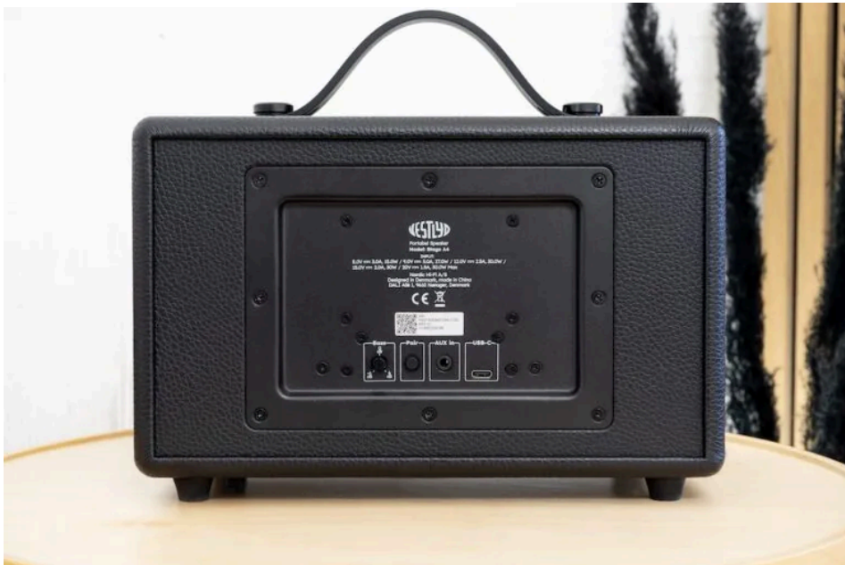
Cooler Feature: Die Bass-Intensität lässt sich über den kleinen Regler links auf dem Anschlussfeld anpassen.
